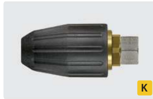
M18 F. Spray angle 20°. 200 - 350 bar. Max. 100 °C
