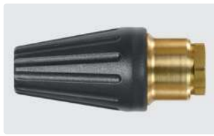
1/4" F. Spray angle 20°. 120 - 250 bar. Max. 100 °C
