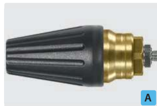
1/8" M. Spray angle 20°. 200 - 400 bar. Max. 100 °C
