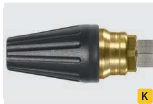
M18 F. Spray angle 20°. 200 - 400 bar. Max. 100 °C
