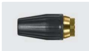
1/4" F. Spray angle 20°. 100 - 250 bar. Max. 100 °C
