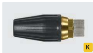
M18 F. Spray angle 20°. 100 - 250 bar. Max. 100 °C
