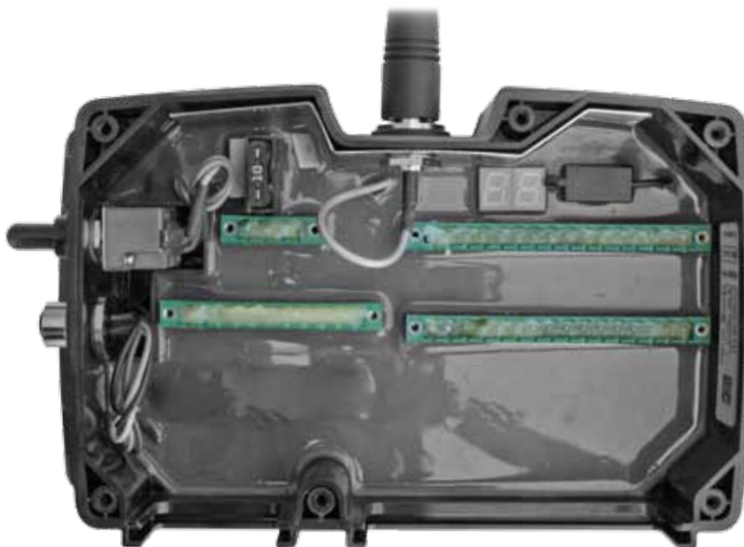
Kuva 5.3 Keskusyksikkö, jonka kansi on poistettu.
