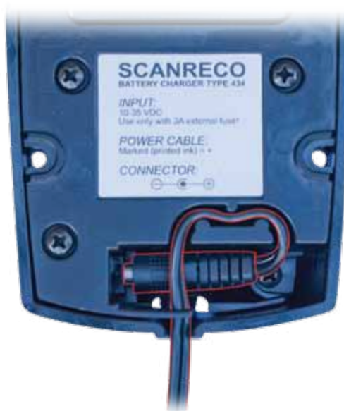
Figure 3.6 Aseta kaapeli kytkennän jälkeen kotelon kaapeliohjaimeen.
